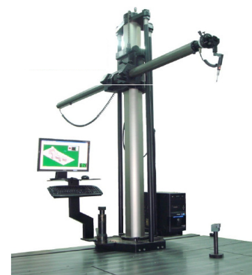
三次元量測設備
