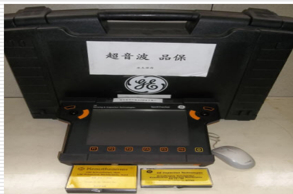
超音波(點焊強度測試)
